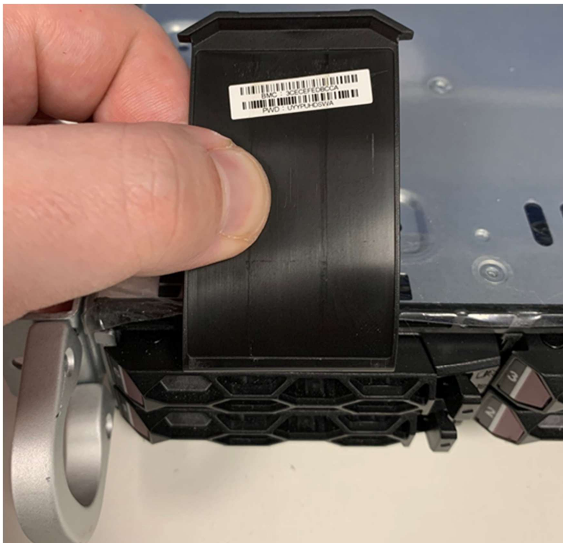
Etiquette de service du serveur indiquant l'adresse MAC du BMC et le mot de passe à usage unique.
