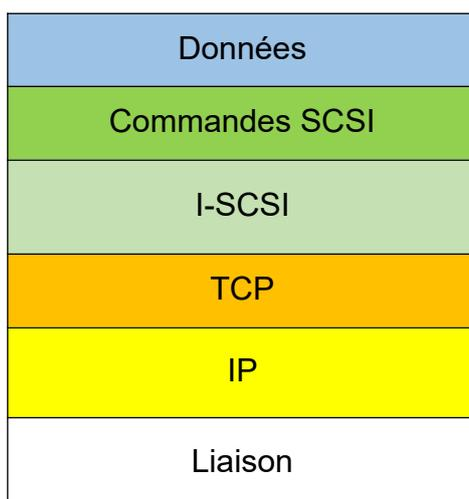
Le principal avantage de l'I-SCSI sur le Fibre Channel est sa simplicité d'utilisation et de déploiement. En effet, l'I-SCSI ne nécessite pas d'infrastructure matérielle dédiée. Il suffit d'utiliser l'infrastructure réseau existante.
