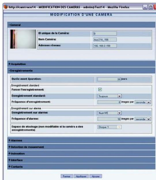
Lors de la déclaration d'une nouvelle caméra vous devez indiquer sur quel disque elle va enregistrer. Cette affectation d'une caméra à un disque se fait soit dans l'interface web *Administration* → *cameras*, dans l'onglet "Enregistrements" (menu ci-contre). Le disque système est représenté par le chiffre « 0 »
